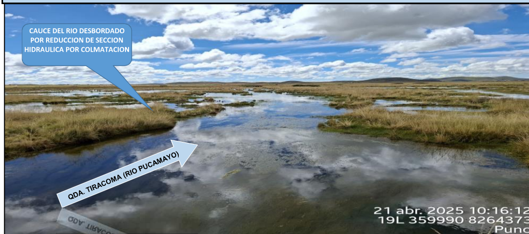
FIGURA 1: TRAMO CRÍTICO EN EL RÍO PUCAMAYO, EN EL SECTOR TIRACOMA, DISTRITO DE CABANA, PROVINCIA DE LAMPA - PUNO. NOTESE, EL DESBORDE E INUNDACION A CAUSA DE LA SEDIMENTACION QUE REDUCE LA SECCION HIDRAULICA DEL CAUCE DEL RIO, A INICIOS DEL CAUCE AGUAS ABAJO DEL PUENTE TIRACOMA.
